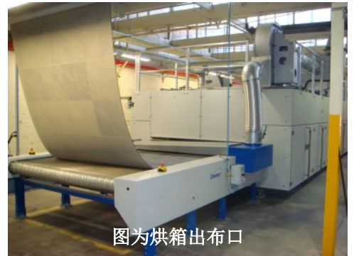
图为在澳大利亚Godfrey Hirst公司的地毯印花生产线: 2.2米宽幅, 16套色 x 256喷嘴/每套色
