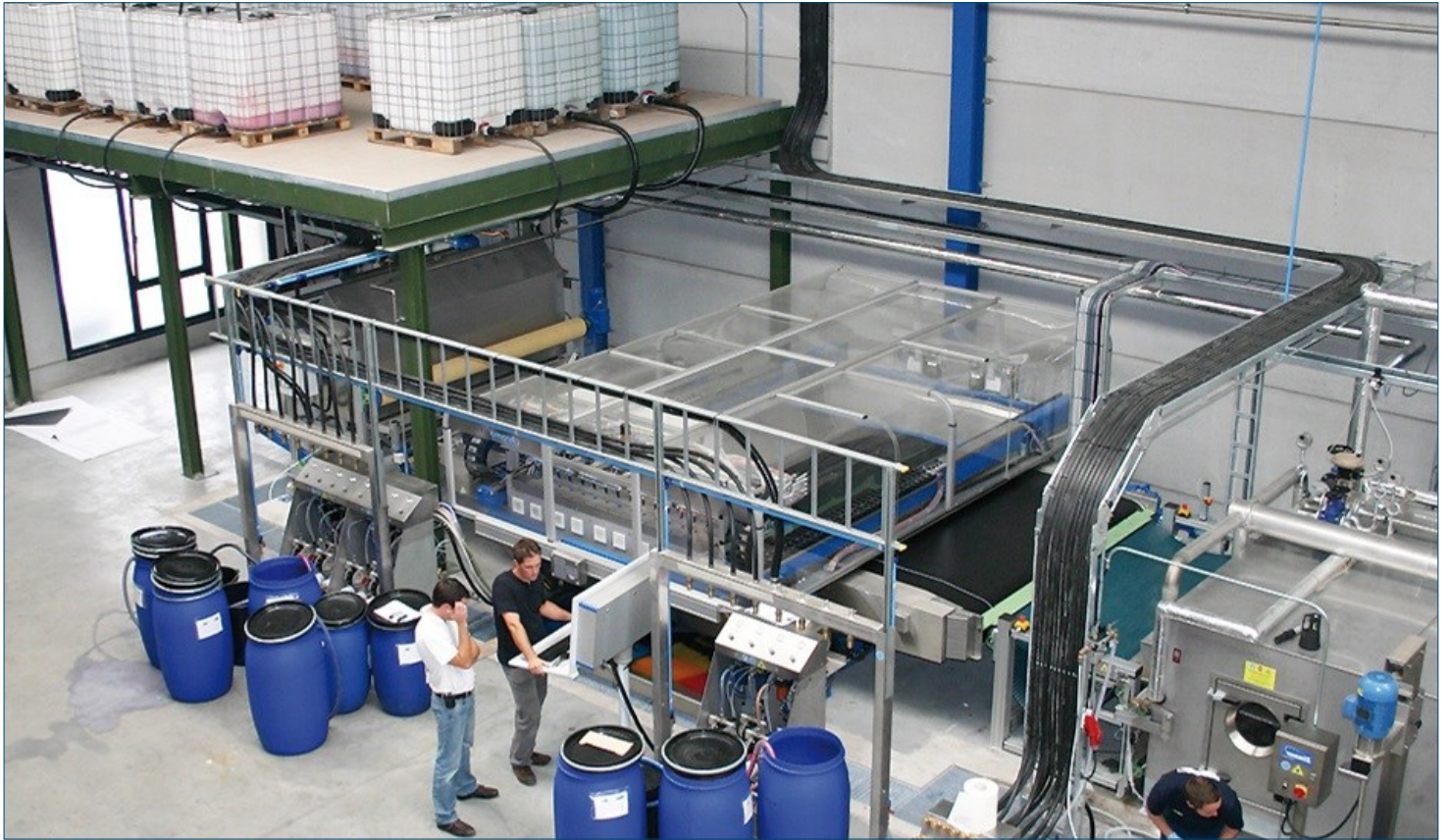
图为ChromoJET800 2米印花机 12套色 X 256喷嘴 /每套色 及供浆系统
